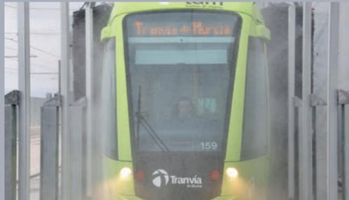
Opcional diseñado para la aplicación eficiente de producto químico de prelavado. Compuesto por dos tuberías orientables de acero inoxidable, boquillas con sistema antigoteo, sistema de dosificación y protectores laterales para minimizar corrientes de aire y optimizar la aplicación del producto químico.
