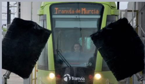
Especialmente diseñado para el lavado específico de la cara frontal y posterior de flotas con catenaria. Dos unidades autónomas ejercen la función de cepillo horizontal con movimiento de posicionado angular que facilita el lavado. Cada unidad dispone de autómata programable, armario de control, circuito de agua y dosificación centralizada de detergente.
