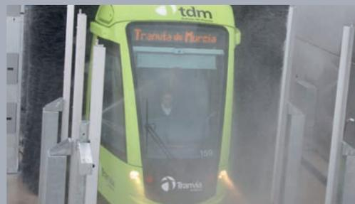
Un baño de cera de secado o cera protectora proporciona un incomparable brillo y protección de la pintura de los vehículos frente a las agresiones atmosféricas. Opcional compuesto por dos tuberías orientables sobre sus ejes y sistema de dosificación centralizada de la cera.
