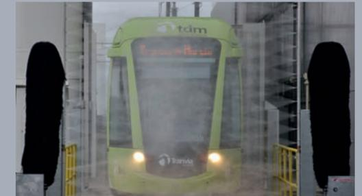
Diseñado para realizar un prelavado de los vehículos con agua a alta presión. La posibilidad de elegir la electrobomba permite variar el caudal y la presión del agua sobre el vehículo a través de sus dos tuberías orientables que incorporan boquillas de acero inoxidable.
