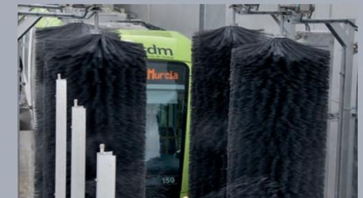
Adicionalmente al grupo de cuatro cepillos verticales del módulo base pueden configurarse hasta 4 grupos de 2 cepillos verticales. Estos cepillos son controlados por un autómata programable, con regulación electro-neumática de la presión y sensores de asistencia al esfuerzo de giro.
