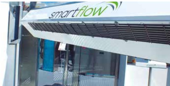
Além do secado completo (laterais+superior copiante) ISTOBAL FLEX5 pode incorporar o novo sistema de secagem horizontal Smartflow patentado por ISTOBAL, para reduzir substancialmente o consumo eléctrico e a emissão de ruído
